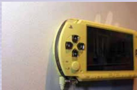
▲PSP支持索尼的记忆棒Memroy Stick DUO,记忆棒的插槽在主机左侧部,可以看到插槽处“Memroy Stick DUO”的字样。另外无线通信功能的开关也处于左侧部,开启或者关闭时不同的指示灯会亮起。从这个画面也能看到立体声耳机的插孔处于主机底部的最左边,靠近系挂机绳的地方。
